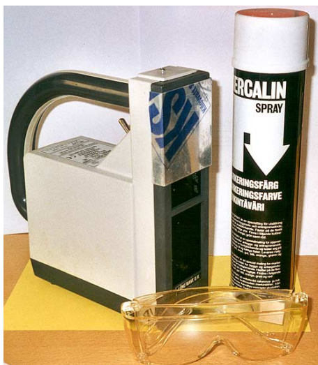
Bild 1 Utrustning för indikering av tjära (UV-lampa + färg).
