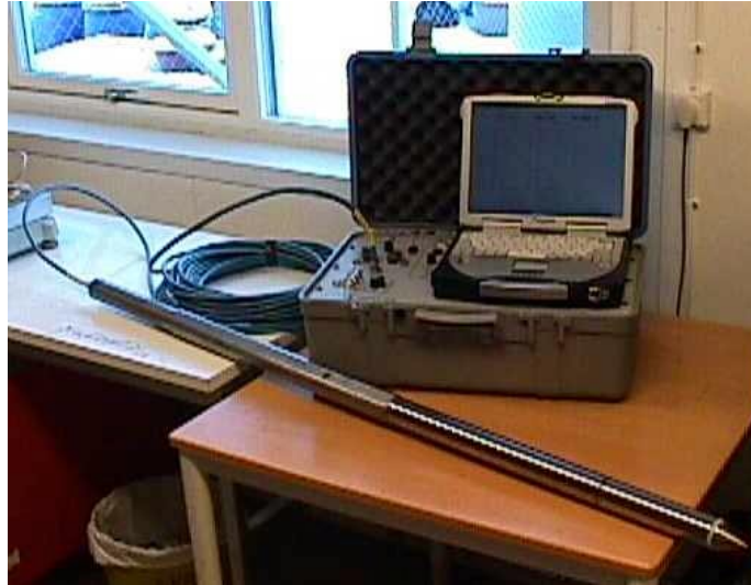
Figur 22. FFD-sond med CPT-spets och ny datainsamlingsutrustning, Datapack 2000.
