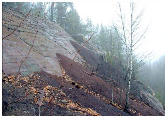
Kisaska finns deponerad på många objekt med förorenad mark. Vid en karakterisering med laktester överskred 15 % av undersökta prover gränsvärdena vid deponi för farligt avfall. Bilden är tagen från Kramfors kommun. (SGI, 2004b)
