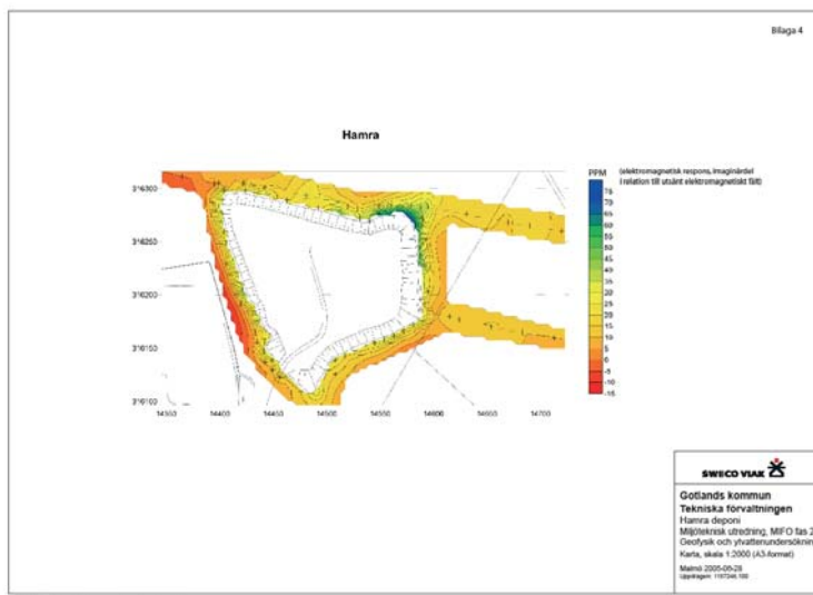
Figur 11b. Exempel på resultat med stångslingram vid undersökning av en nedlagd deponi på Gotland. (Utförts av Sweco Viak på uppdrag av Gotlands kommun)
