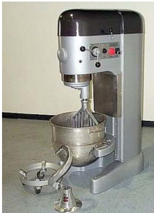
Figur 1. Stor degblandare lämplig för homogenisering av torv.
