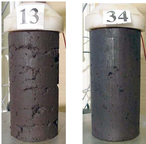
Figur 6. Exempel på provkropparnas utseende. Prov 13 är tillverkad med metod III och prov 34 med den traditionella SGI-metoden.
