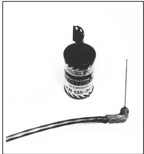
Figur 23. Sond för bestämning av värmeledningsförmåga.
