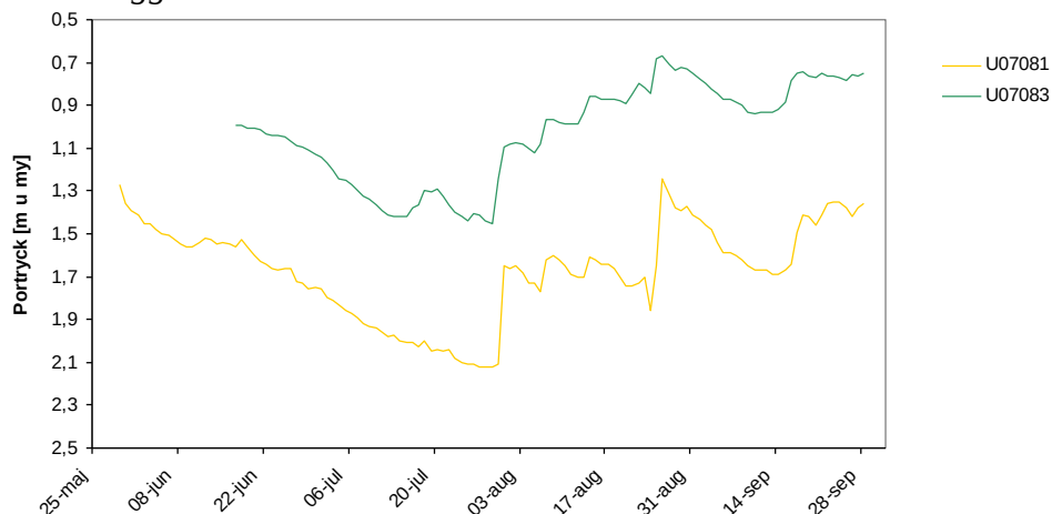
Figur 5-8 Registrerat portryck på djupet 3 m genom hela sektion E26360. Mätpunkt U07081 ligger närmast älven.
