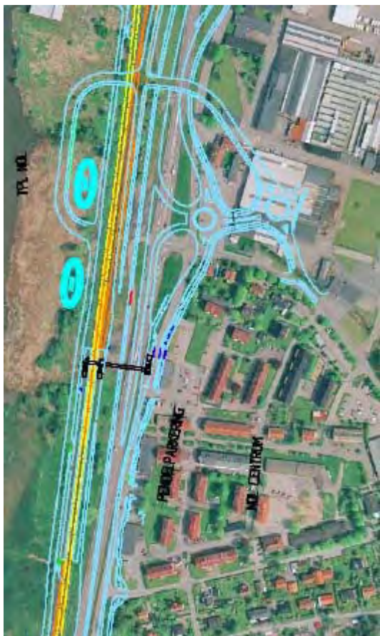
Figur 2 Ritning över ny sträckning av E45 och dubbelspår genom Nol. Järnväg är märkt med gult och orange. Ny väg markeras med blått (BanaVäg i Väst, 2008).
