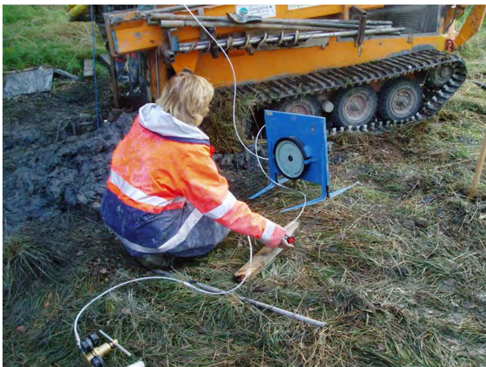
Figur 13 Justering av lufttrycket i tryckledning och spalt under provet.
