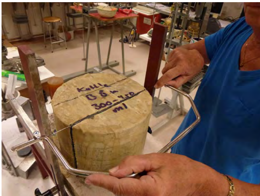
Figur 22 Snittning i utskärningsrigg
