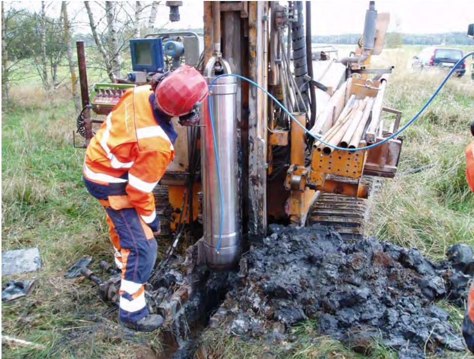
Figur 11 Provtagare upphängd i neddrivningsutrustningen
