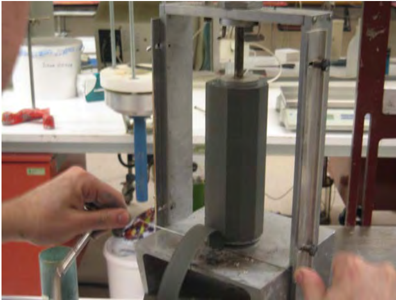
Figur 23 Trimming av diametern för ett delprov avsett för triaxialförsök.
