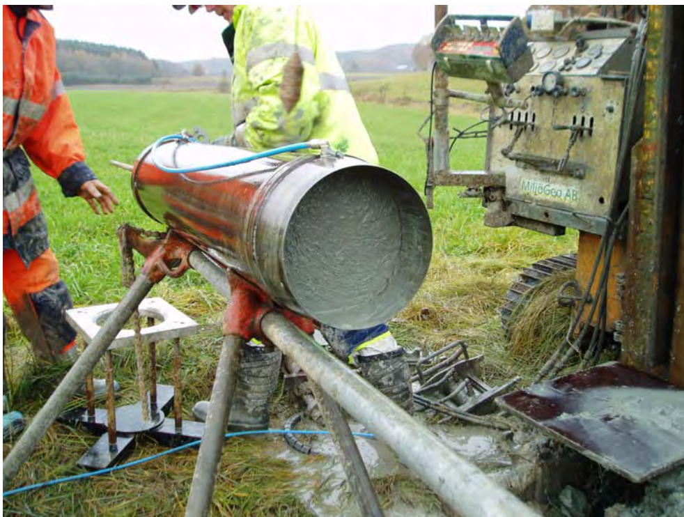
Figur 15 Rengjord provtagare på rörbock. Provets avskurna underyta syns inuti eggen.
