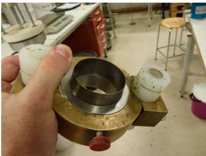
Figur 24. Infettad egg och provhållarring i stansapparatens överdel
