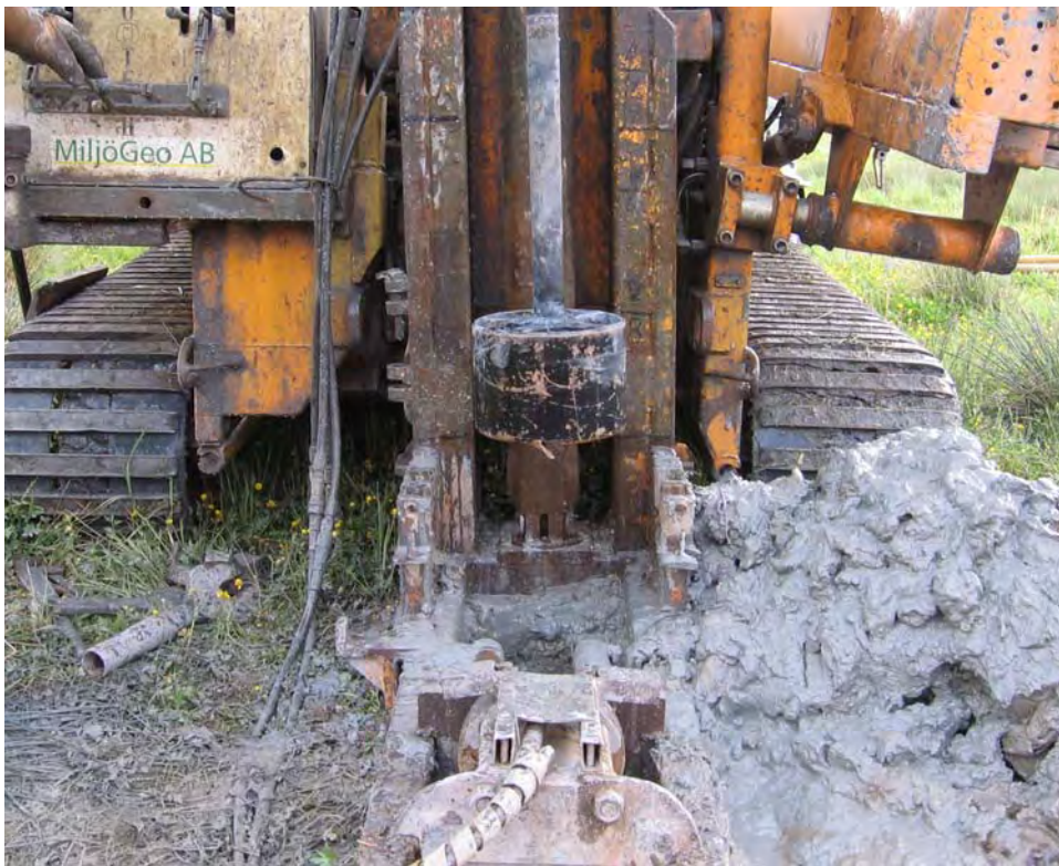
Figur 10 Verktyg för rensning av hålbotten
