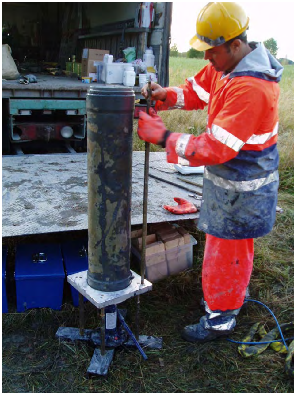
Figur 16 Montering av provtagarrör i uttryckarrigg
