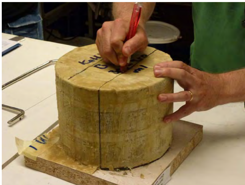
Figur 21 Markering av snitt och borttagning av förslutning
