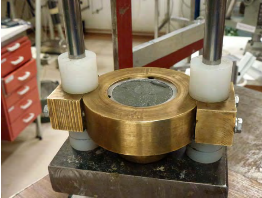
Figur 26 Instansat prov strax innan ändläget.
