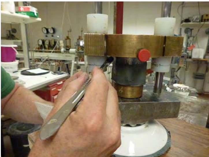
Figur 25 Instansning av prov och successivt avlägsnande av bortstansat material
