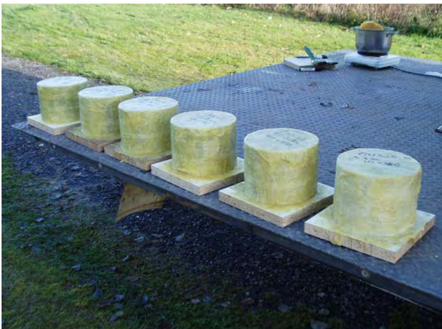
Figur 19. Förslutna prover från en provtagningsnivå
