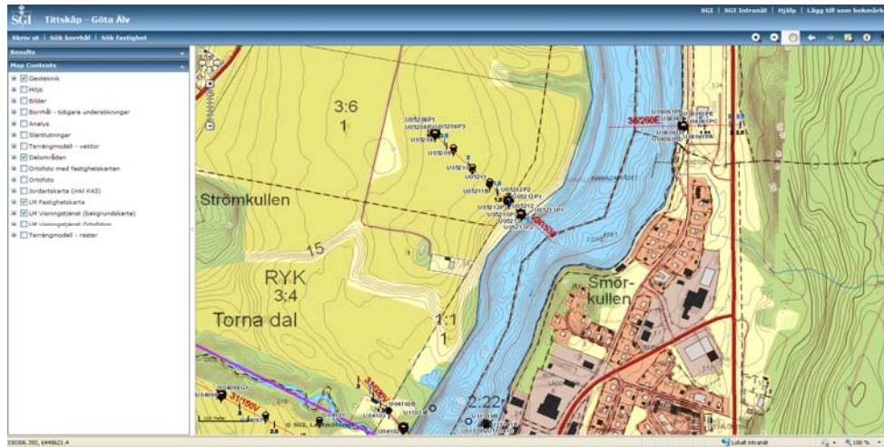
Figur 2-4 Exempel från Tittskåp Göta älv. Presentation på fastighetskartan av undersökningssektioner, borrhål och höjdkonturlinjer. Bakgrundskarta © SGI, Lantmäteriet.
