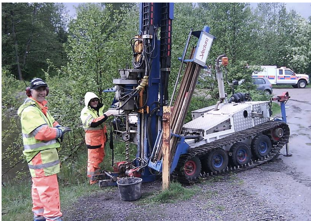
Figur 3.2 Borrbandvagn vid provtagning och fältundersökning på land.
