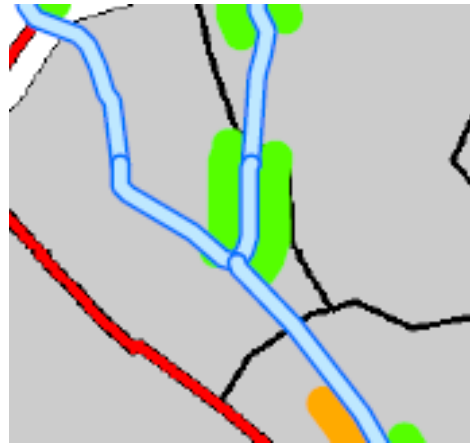
b) Stranderosion. Översiktlig inventering av erosionsförutsättningar (SGI). Grön färg innebär att området består av svämsediment, se Tabell 4.6 och Avsnitt 4.3.3. (© SGI, Lantmäteriet, Geodatasamverkan)
