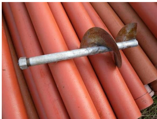
Figur 3.2 Spets av skruvpegel. (Foto SGI).
