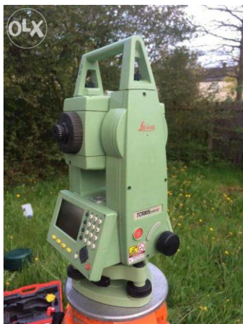
Figur 3.11 Till vänster, totalstationen mäter riktningar i vertikalled, horisontalled och distanser, till höger ett mätprisma av typ Leica GPR112. (Från Leica Geosystems 2015).
