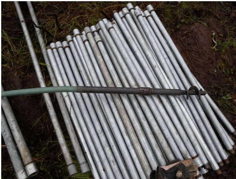
Figur 3.5 Bälgslangens bottenskruv inklusive monterad bälgslang, till vänster i bilden en grön plastslang. (Foto SGI).
