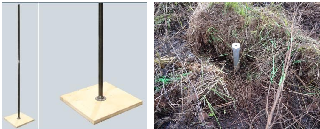
Figur 3.1 Till vänster visas en bild på en markpegel före installation och till höger visas en färdiginstallerad markpegel. (Foto SGI).
