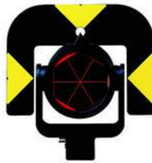
Figur 3.11 Till vänster, totalstationen mäter riktningar i vertikalled, horisontalled och distanser, till höger ett mätprisma av typ Leica GPR112. (Från Leica Geosystems 2015).
