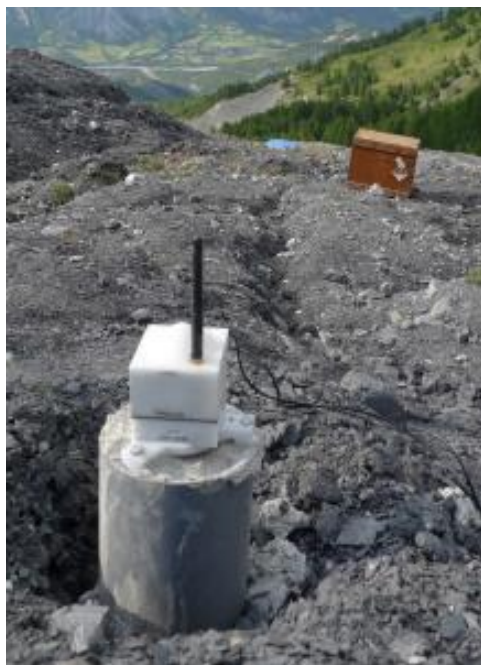
Figur 3.14 Installation av GéoCubes. (Se Benoit et al. 2014).
