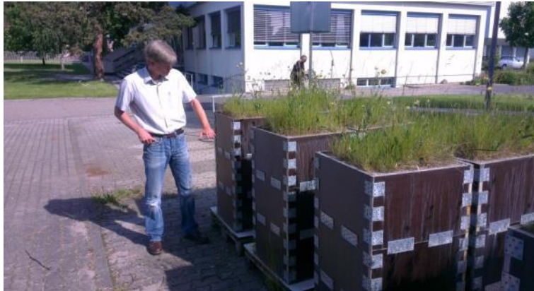
Figur 61 Skjuvboxar för skjuvförsök i BAW laboratorium (Foto: P. Danielsson, SGI).
