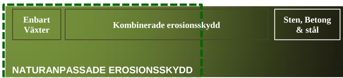
Figur 22 Olika typer av erosionsskydd i en skala från mjuka till hårda (Illustration: P. Danielsson).
