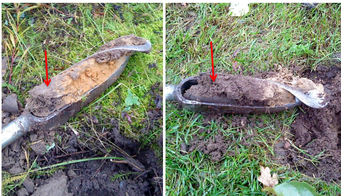
Figur 6.3 Foton som visar hur jordlagerföljden kan variera i olika provpunkter. I båda profilerna ses ytlig matjord (markerad med pilar), men med varierande mäktighet. Därunder syns naturlig sand. (Foto: SGI)
