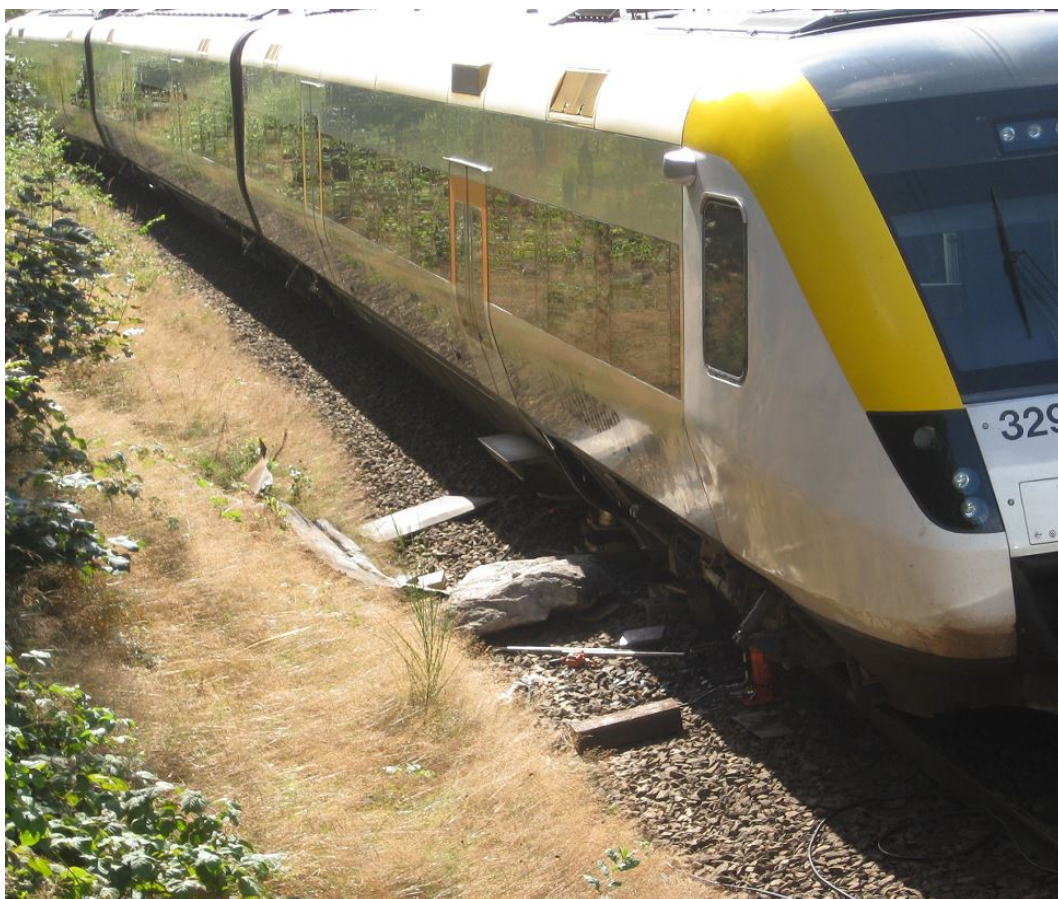
Figur 14. På bilden syns blocket där det slutligen hamnade efter att tåget släpat det med sig och fått stopp. Foto: Hans Hargelius.
