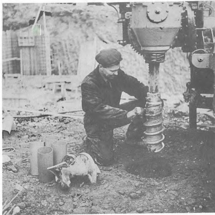
Fig. 6. Montering av den specialkonstruerade provtagaren. T v syns provburkar samt skruvborren (augern) till förborringen.
