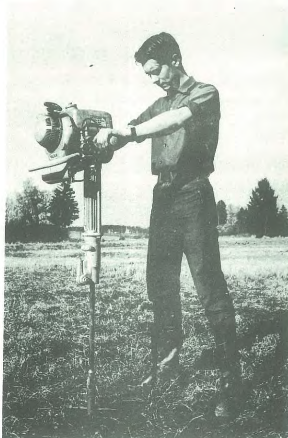
Fig. 3. Provtagare av kolvborrtyp för upptagning av störda jordprover ( \varnothing 27 x 300 mm) i fasta jordlager. Neddrivningen sker med en motorslagborrmaskin WACKER 25.
