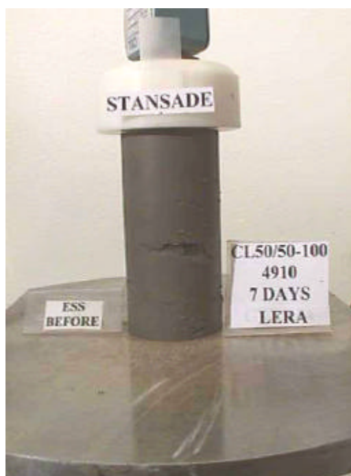
Le 1; stansad; 7 dygn; \tau_{\text{normaliserad}}=97\%
