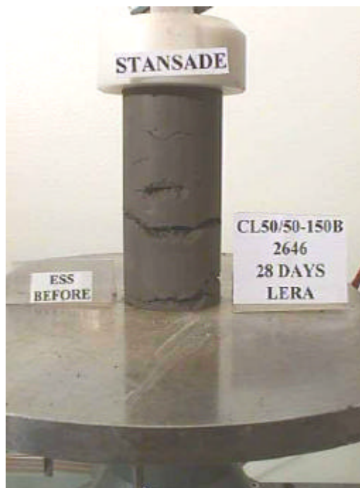
Le 2; stansad; 28 dygn; \tau_{\text{normaliserad}} = 64 \%
