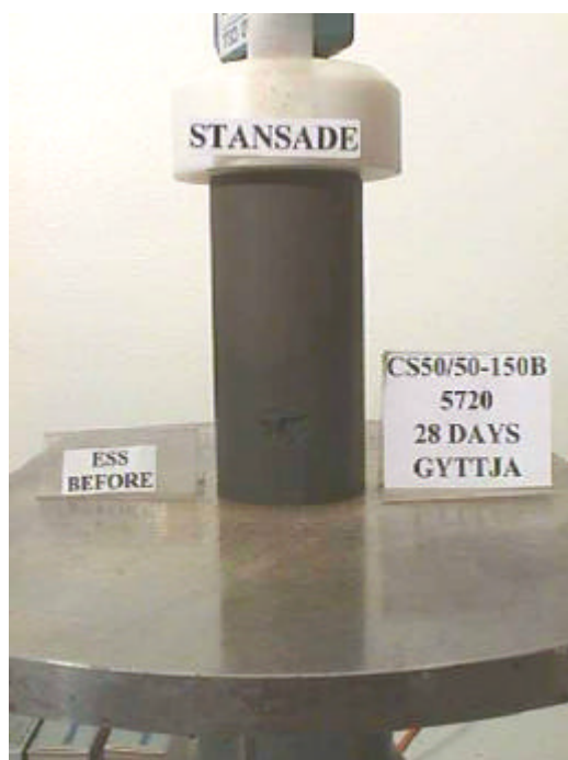
Le Gy 2; stansad; 28 dygn; \tau_{\text{normaliserad}}=94\%
