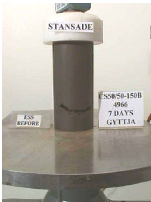
Le Gy 2; stansad; 7 dygn; \tau_{\text{normaliserad}}=49\%
