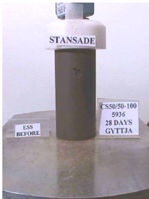
Le Gy 1; stansad; 28 dygn; \tau_{\text{normaliserad}}=100\%
