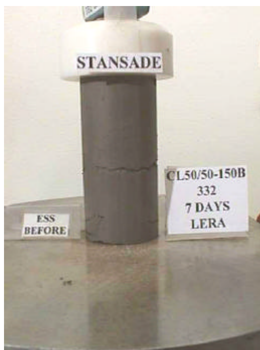
Le 1; stansad; 7 dygn; \tau_{\text{normaliserad}} = 80 \%
