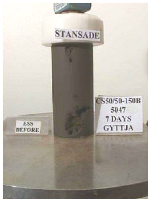
Le Gy 2; stansad; 7 dygn; \tau_{\text{normaliserad}}=103\%
