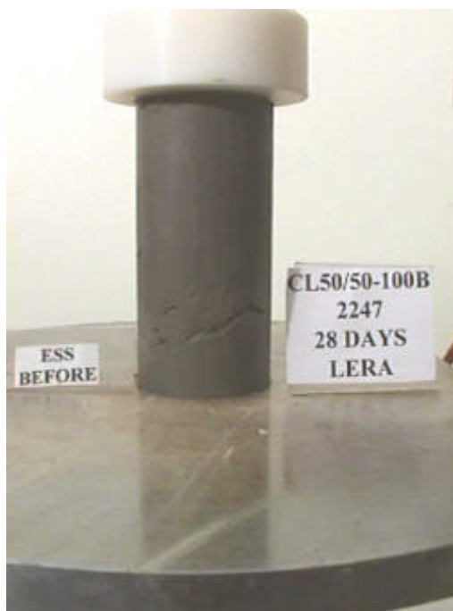
Le 1; stansad; 28 dygn; \tau_{\text{normaliserad}} = 77 \%
