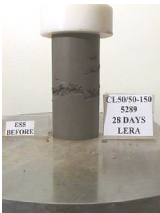
Le 2; stansad; 28 dygn; \tau_{\text{normaliserad}} = 74 \%
