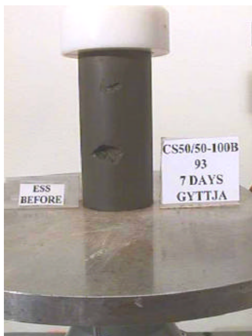
Le Gy 1; stansad; 7 dygn; \tau_{\text{normaliserad}}=75\%
