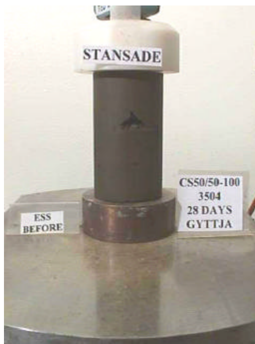
Le Gy 1; stansad; 28 dygn; \tau_{\text{normaliserad}}=62\%
