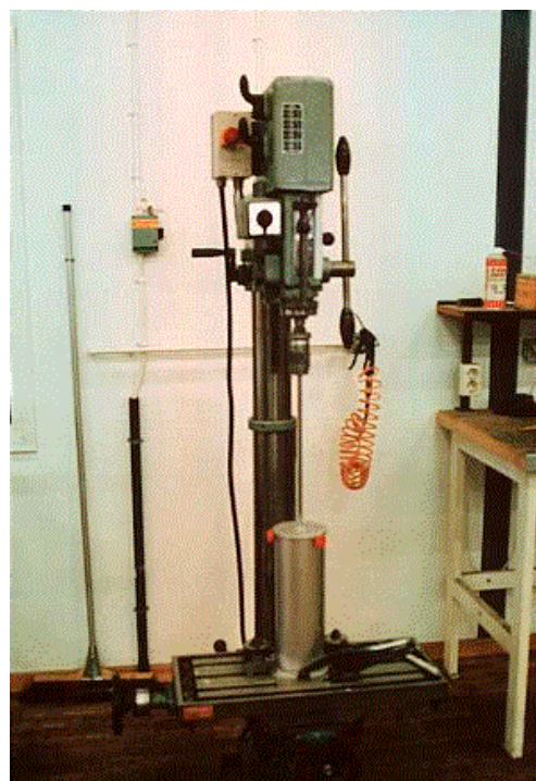
Figur 1. Ingående delar i blandningsutrustningen. a) Från vänster till höger ses blandarcylindern; blandarverktyget med tillhörande stång och blandarcylinderns lock; KC-rör och KC-plugg i änden på en stång för ifyllning av stabiliseringsmedel. Längst till höger har en kolvborrhylsa placerats som referensobjekt med avseende på utrustningens storlek. b) Blandarutrustningen monterad i bormaskinstativ
