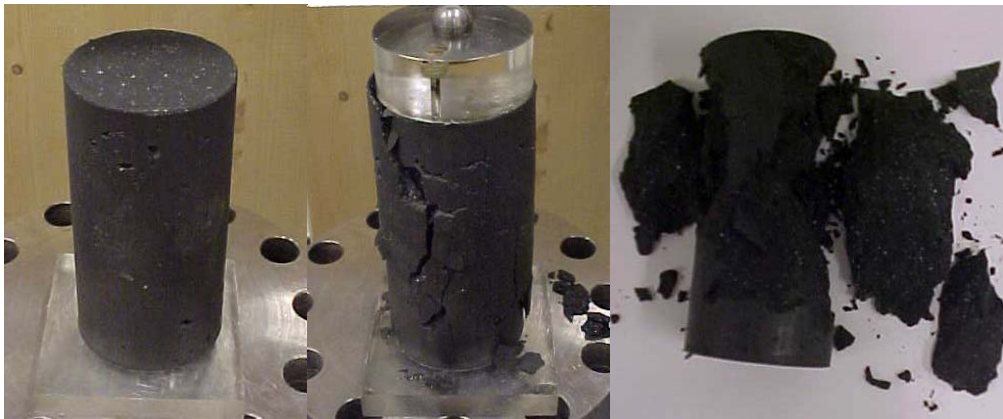
Figur 5-9 Provkropp före och efter tryckning samt isärbruten.
