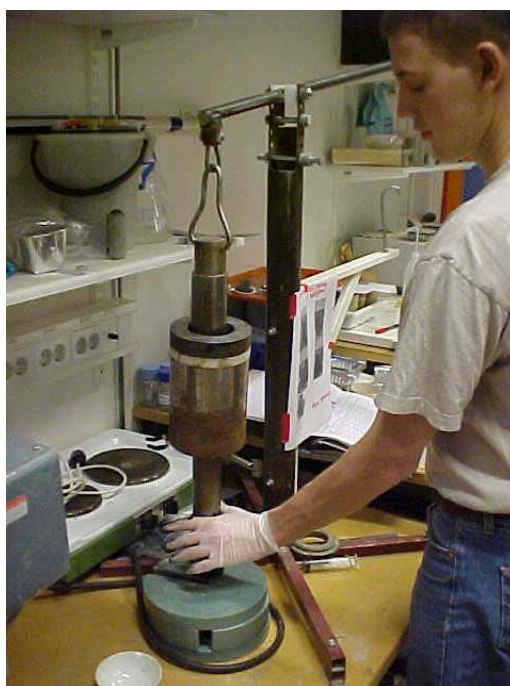
Figur 5-6 Packning med 100 kPa tryck under 5-6 sek för varje nytt tillfört lager.
