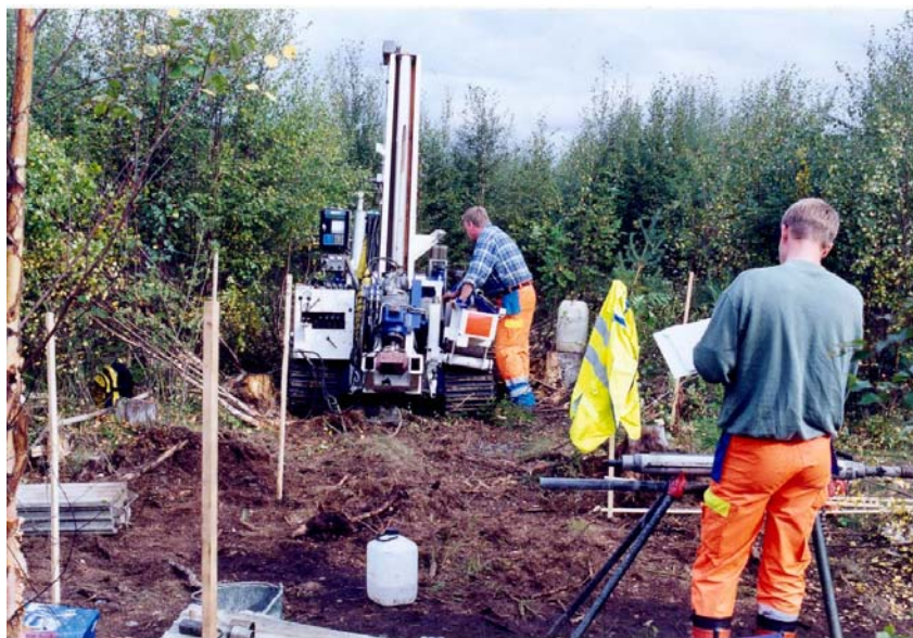
Figur 4-10 Borrbandvagn vid kolvprovtagning.
