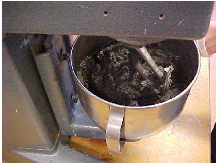
Figur 5-4 Blandning av jord och bindemedel i en degblandare.
