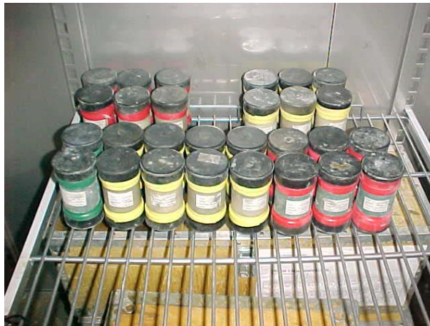
Figur 5-7 Lagring av provkroppar i kylskåp med temperatur +7\text{ }^{\circ}\text{C} .
