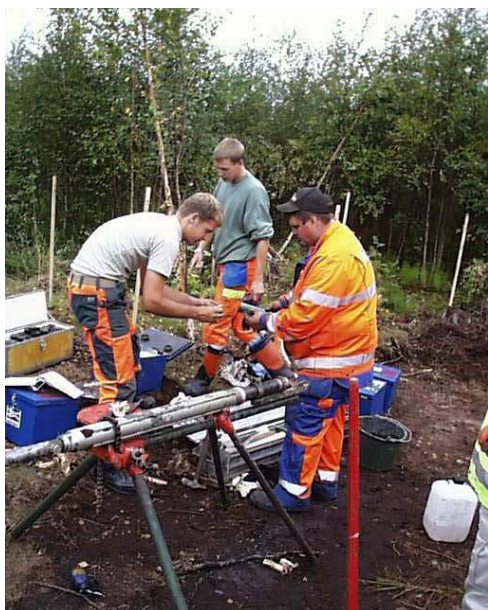
Figur 4-12 Ändytorna på provtuberna beläggs med plastmellanlägg och försluts med lock.
