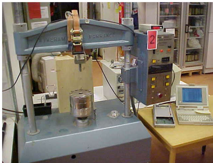
Figur 5-8 Försöksupställning för enaxiellt tryckförsök med tillhörande logger och dator.
