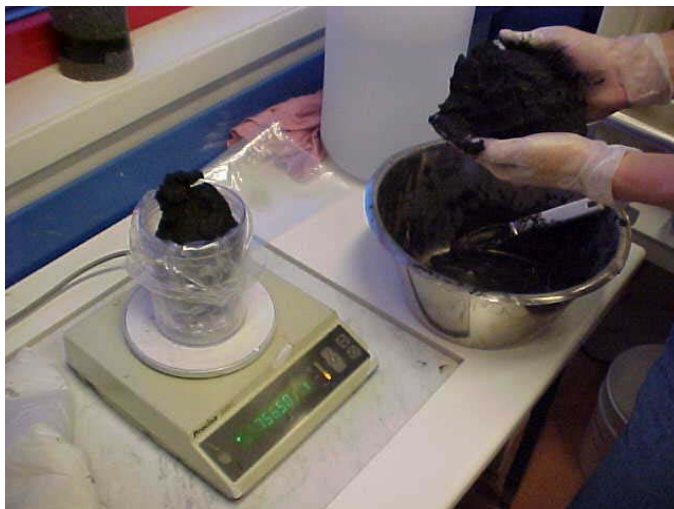
Figur 5-2 Vägning av omrörd naturlig jord och fördelning till ett antal mindre volymer.
