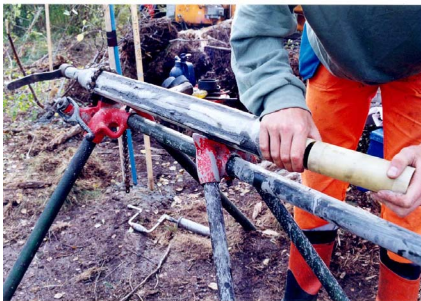
Figur 4-11 Omhändertagande av ostörda prover i provtuber.
