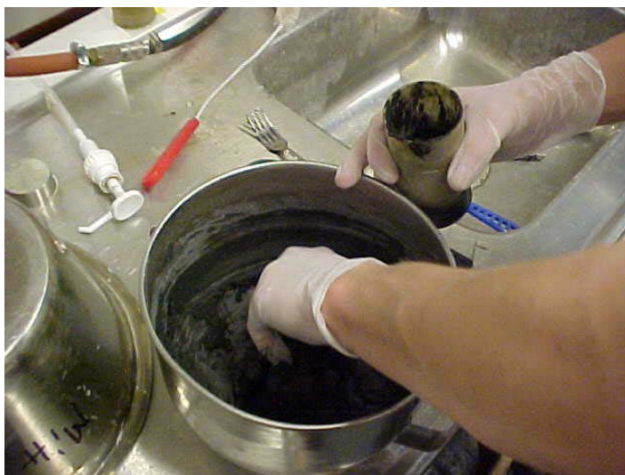
Figur 5-5 Ifyllning av material i provtub, ungefär 2 cm tjocka lager åt gången.
