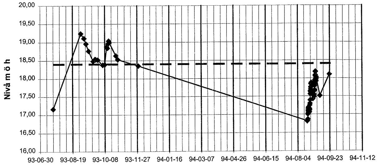
FIGUR B6:5 Prästtjärn. Långtidsmätning av grundvattennivå i GW-rör 18/800 H22 1993-94.
