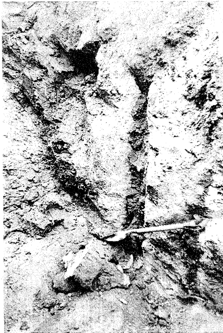
Figur 33 - pælstrukturen kan observeres tydelig ved utgraving - ved landbruksundergangen på Eskelund - dobbeltsporparsellen Såstad-Haug
