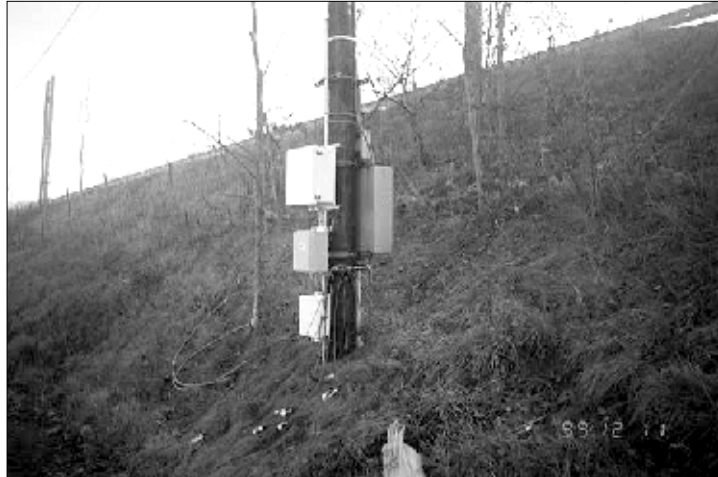
Figur 3.2 Fältmontering av ett TDR mätsystem för automatisk datainsamling och övervakning. (O'Connor och Dowding, odaterad)
