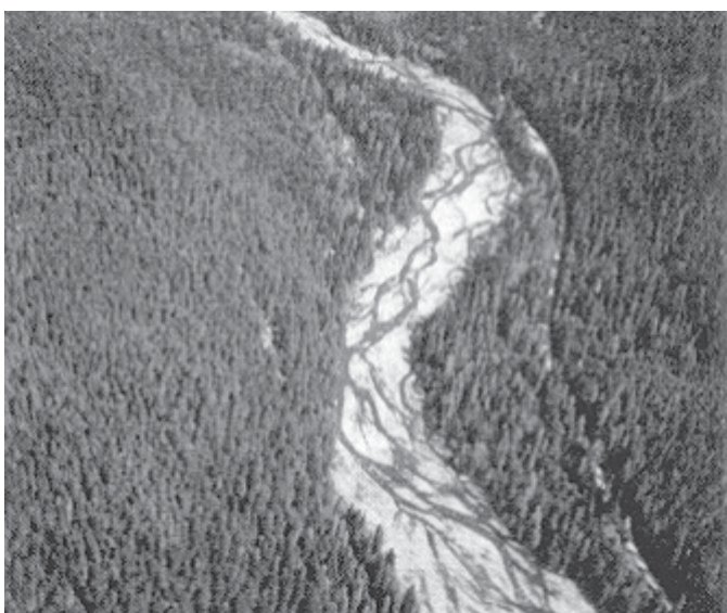
Figur 2-3. Flätat vattendrag (från Corps of Engineers, 1994a ).
