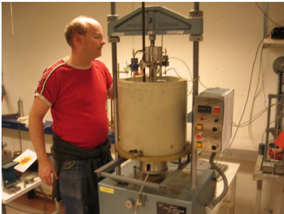
Fig. 10. Konsolidering av stort lerprov i ödometerpress. (Foto SGI)
