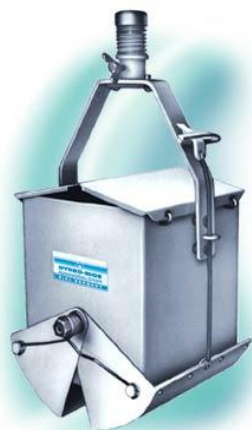
Figur 6-22. Ekmanhuggare för provtagning av hårdare bottensediment ( www.hydrobios.de )
